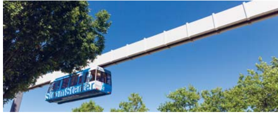
Alleinstellungsmerkmal: Die fahrerlose H-Bahn verbindet die beiden Campusorte miteinander sowie die Universität mit dem Technologiepark und dem Stadtteil Eichlinghofen. Foto: Felix Schmale
