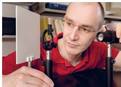
Ein Erfinder bei der Arbeit: Mit Hilfe einer solchen 3D-Kamera soll in Zukunft die Netzhaut obelichtet werden. Hier richtet Holger Sommer sie für einen Versuch zur Auflösungsbestimmung aus. Foto: Roland Baege
