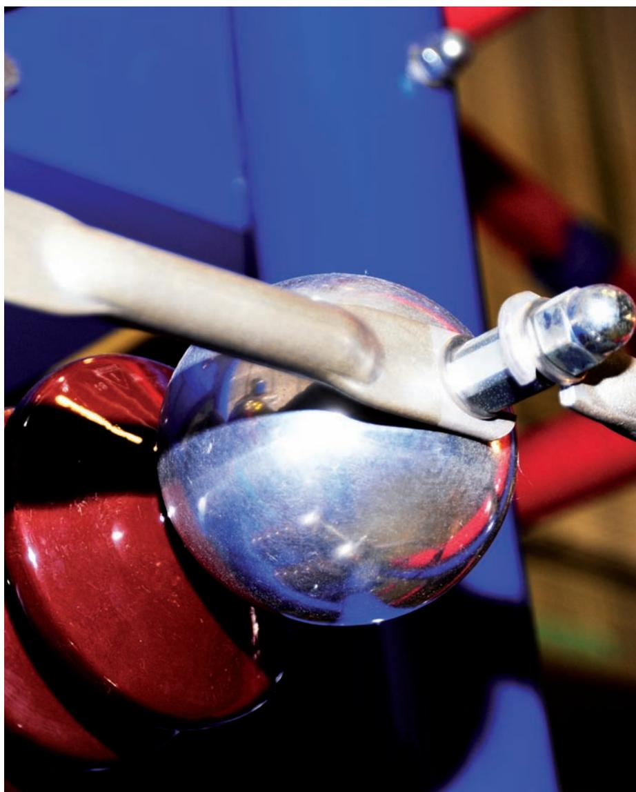
Die silbernen Kugeln stellen Details von Elektroden zur Verschaltung von Bauelementen für einen Stoßgenerator dar.
