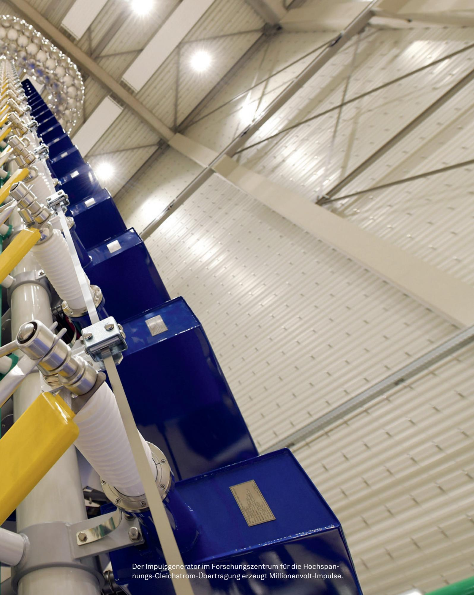
Der Impulsgenerator im Forschungszentrum für die Hochspannungs-Gleichstrom-Übertragung erzeugt Millionenvolt-Impulse.
