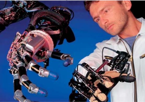
Die vom DLR entwickelte Vierfingerhand besitzt an jedem Finger über 25 Sensoren zur Erfassung von Positions-, Kraft- und taktilen Informationen. Bild: DLR
