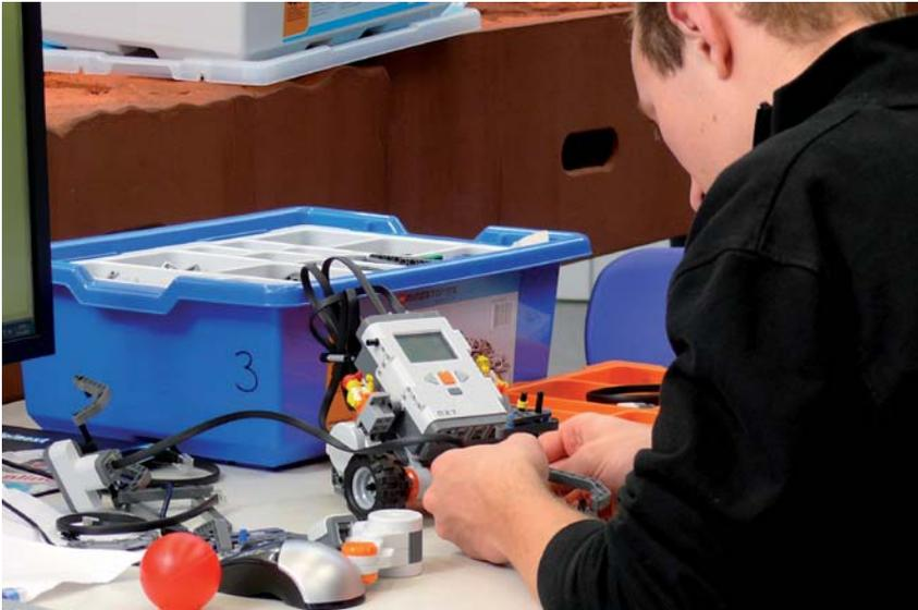
An die LEGO NXT®-Roboter lassen sich verschiedene Sensoren anbringen. Mittels der Sensor-Werte kann die Navigation des Roboters programmiert werden.
