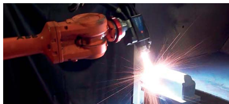
Der Spritzbrenner trägt eine Hartstoffschicht auf ein Werkzeug auf, das für die Herstellung einer B-Säule aus Blech für die Automobilindustrie verwendet wird. Foto: TU Dortmund
