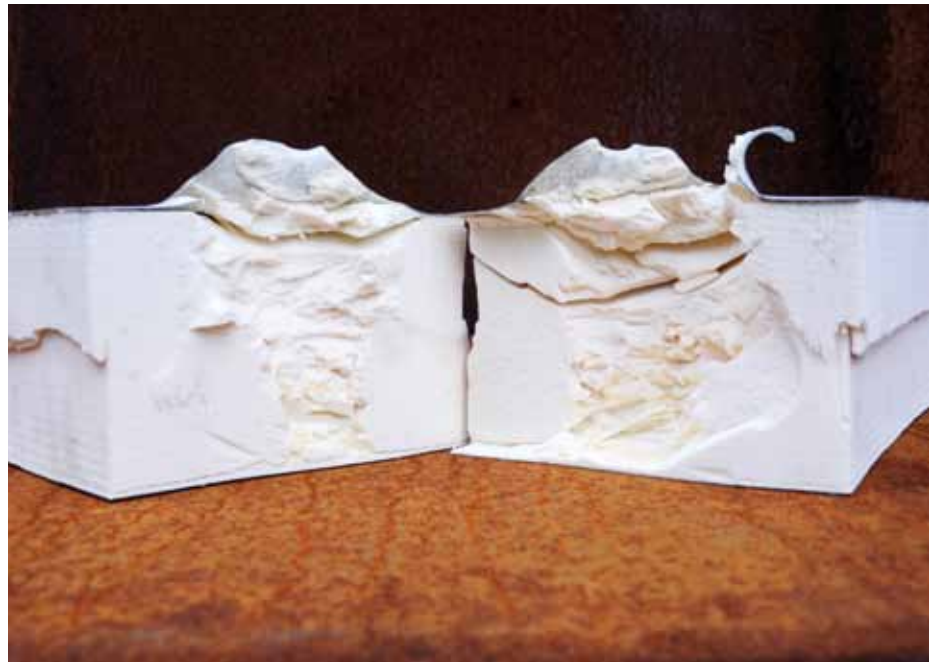
Im Labor werden neue Verankerungsmöglichkeiten für Stahl-Sandwichelemente auf Herz und Nieren geprüft.
