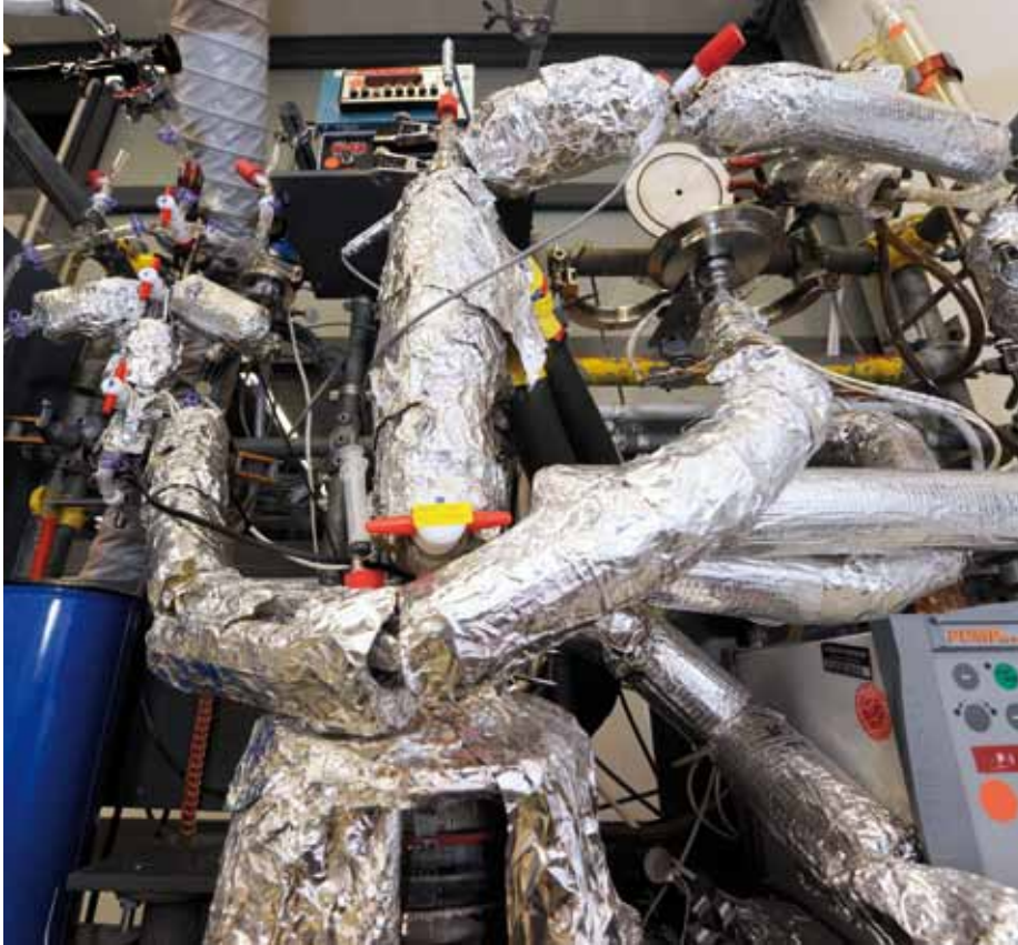
Die Fotos zeigen einen Membranreaktor (oben) und einen Feststand für Pervaporationsmembranen.
