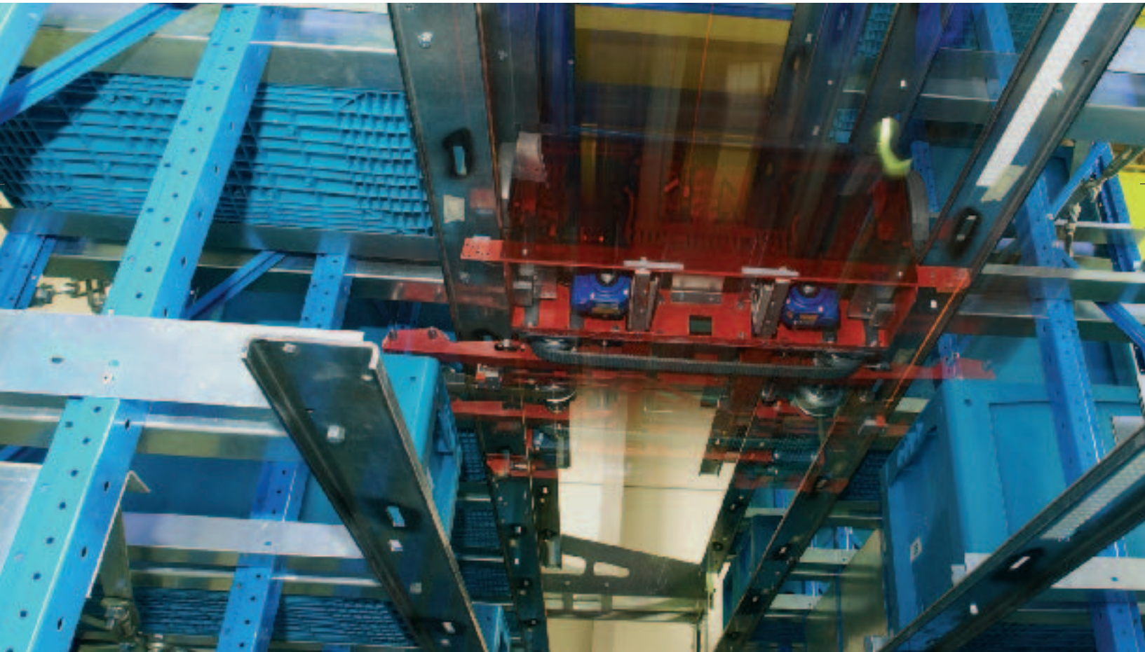
Schlittenartige Fahrzeuge laufen vollautomatisch auf den Metallträgern des Lagers, über die sie auch mit Strom versorgt werden.
