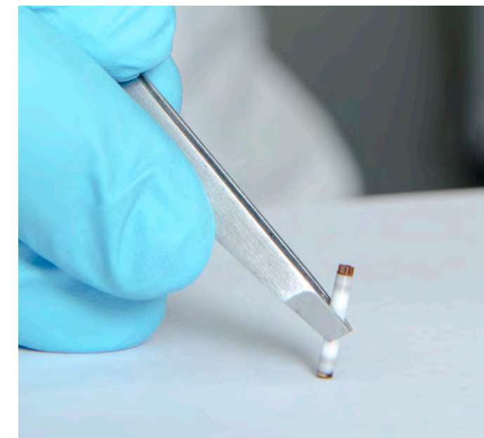
Ultraschnell und winzig klein: Prof. Rasmus Linser untersucht mit NMR-Spektrometern die Bewegungen von Proteinen im Bereich von Piko- bis Millisekunden. Die Proteine befinden sich bei der Untersuchung in Lösung oder in Festkörpern in einem winzigen Röhrchen (rechts), das extrem schnell rotiert.
