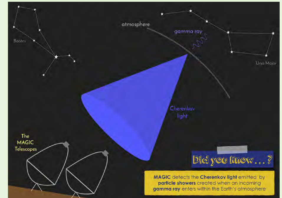
Wenn Gammastrahlung aus dem Universum auf die Erdatmosphäre trifft, hinterlässt sie einen extrem schnellen Teilchenschauer. Die schnellen Teilchen wiederum zeigen sich am Himmel als bläuliche Tscherenkow-Lichtblitze. Und genau diese beobachten die MAGIC-Teleskope auf La Palma.
