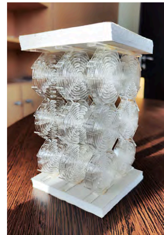
Prof. Madeo und ihr Team haben ein Metamaterial entwickelt, in dem akustische Wellen nicht übertragen werden (s. 3D-Modell links). Zufällig ähnelt dessen Struktur einem Steinfliesen-Bild auf dem Boden in der Kathedrale von Chartres in Frankreich (rechts).
