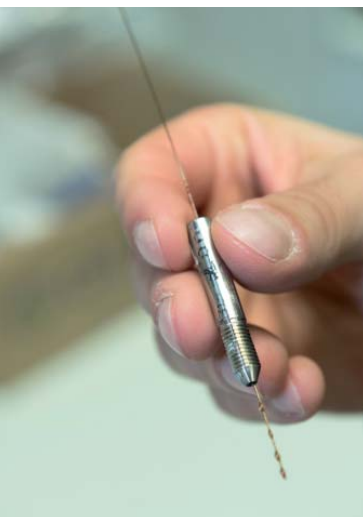
Solche Quarzkapillaren brauchen die Wissenschaftlerinnen und Wissenschaftler für spektroskopische und mikroskopische Untersuchungen an Proteinen. Diese Hochdruckkapillaren halten Drücke bis 2.000 bar aus (oben). Unten im Bild fixiert Christian Anders aus dem Team von Prof. Roland Winter die Quarzkapillare.
