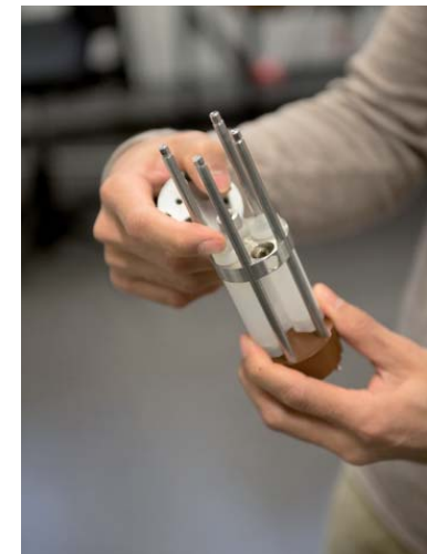
Dr. Trung Quan Luong, Postdoc im Team von Prof. Roland Winter, schließt den Hochdruckautoklaven, der es erlaubt, enzymkinetische Messungen bis 2.000 bar durchzuführen (oben). Unten im Bild sieht man den Probeneinsatz für die Untersuchung.
