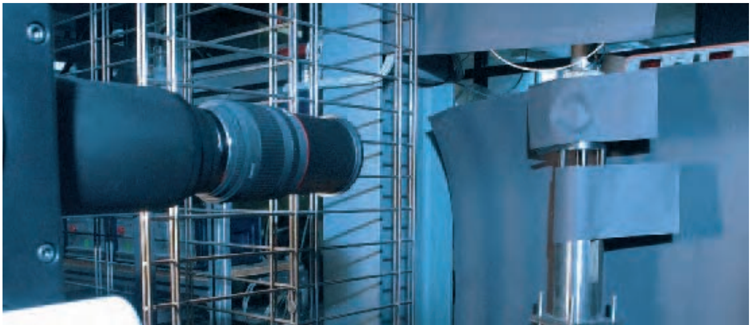
Die Hochgeschwindigkeitskamera erfasst Prozesse im Mikrosekundenbereich.
