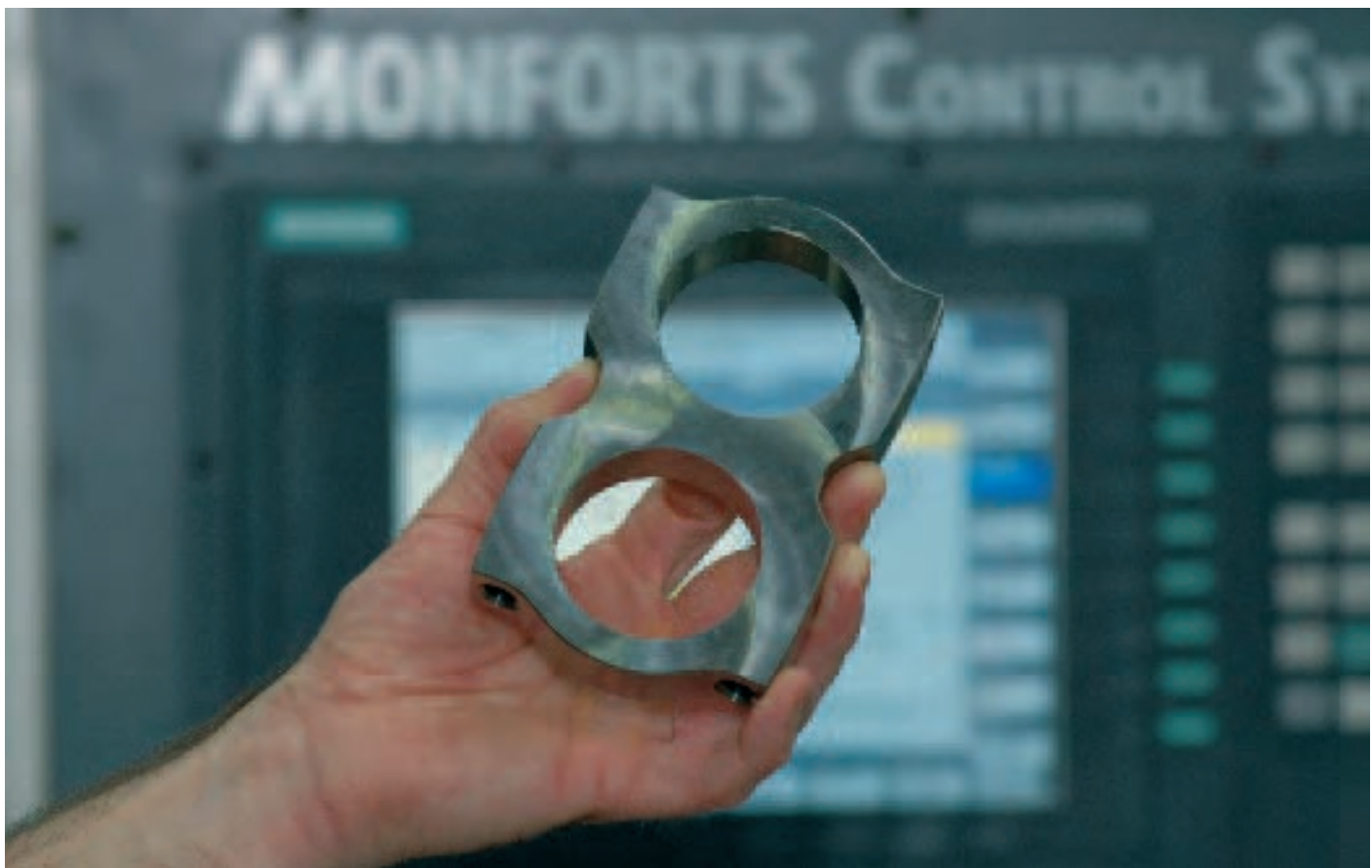
Ein Pleuel aus Titanaluminid spart Gewicht und somit auch Sprit.
