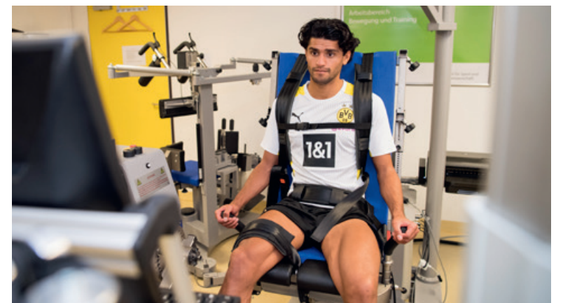
Die Kraft der Beinmuskulatur von BVB-Spieler Mahmoud Dahoud wird mit isokinetischen Messgeräten getestet. Foto: BVB
