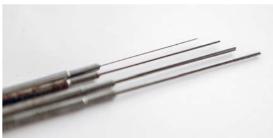
Beim BTA-Tiefbohren sind die Bohrtiefen viel größer als die Durchmesser. Foto: Nikolas Gaisch
