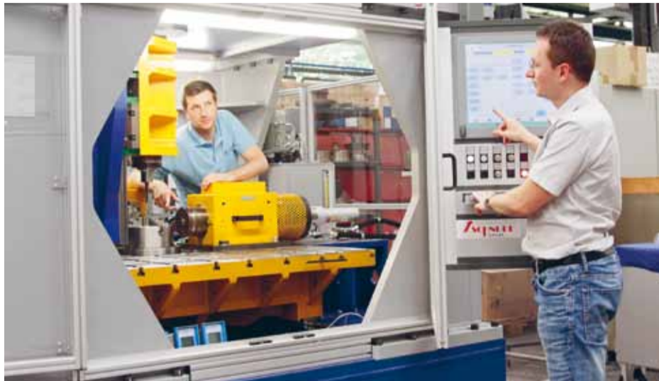
Wurde vom IUL im Rahmen des TR 73 konzipiert: diese neuartige Fünffachs-Pressen zur flexiblen Bearbeitung bei der inkrementellen Umformung. Foto: IUL
