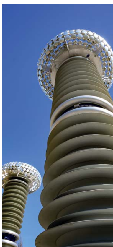
Diese zwei Türme sind Teil des neuen HGÜ-Testzentrums. Die silbernen „Toroide“ sind Kondensatoren, die Entladungen verhindern sollen. Die Wissenschaftlerinnen und Wissenschaftler werden im Forschungszentrum genau beobachten, wie sich die Materialien unter Hochspannung verhalten. Wahrscheinlich müssen im Zuge dessen ganz neue Materialien entwickelt werden. Foto: Oliver Schaper
