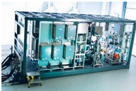
So sieht ein Produktionscontainer aus: Hinter einer solchen modularen Anlage steckt viel Logistik – diese erforscht das Projekt ModuLOG. Foto: Bayer Technology Services
