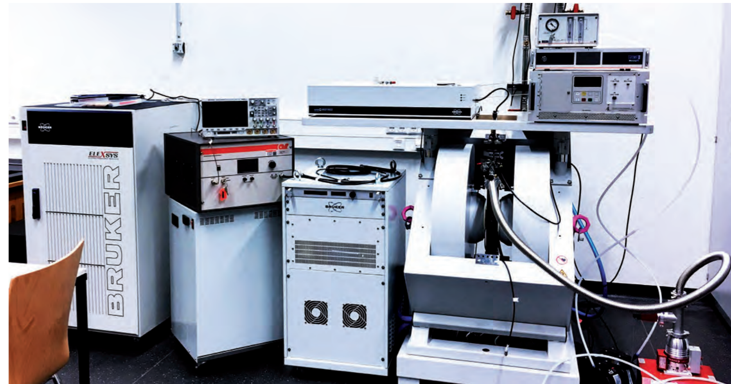
In einem Spektrometer werden Proben in einem Magnetfeld untersucht. Dadurch werden ungepaarte Elektronen in Proteinen sichtbar. (Quelle: Müge Kasanmascheff)
