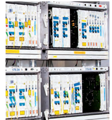
Oben: Im Modenmultiplexmessplatz werden die Moden verschiedenen Komponenten zusammengekoppelt und getrennt.
