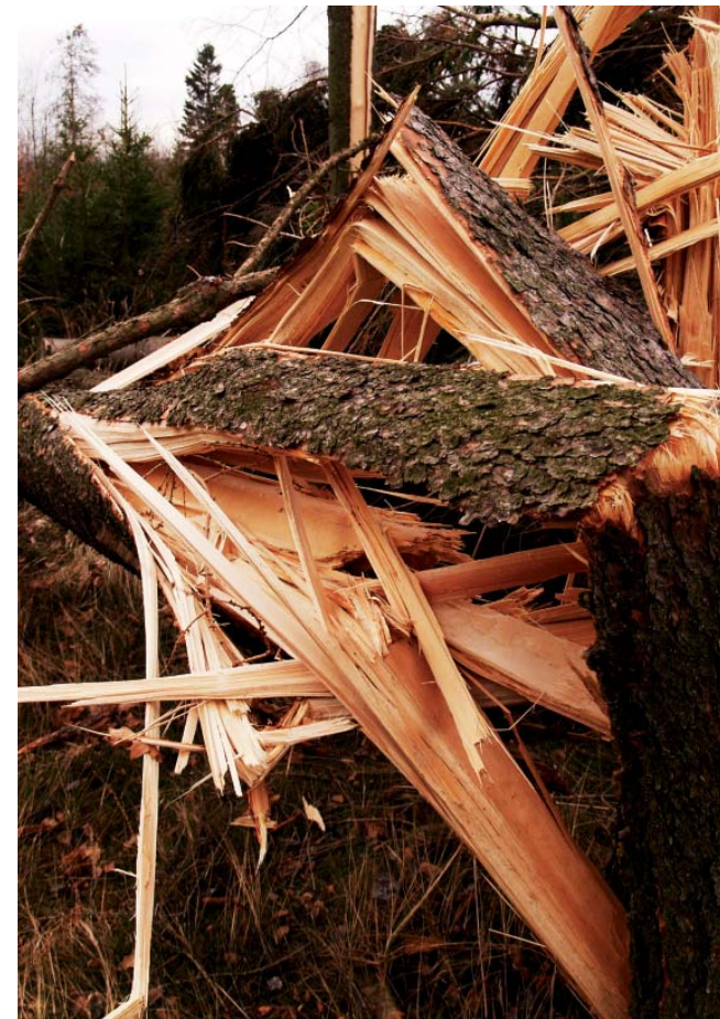
Trockenes Holz bricht viel leichter als feuchtes. Die Erklärung dafür ist das „Zwei-Komponenten-Material“: Die Flüssigkeit im nassen Holz wird bei Krafteinwirkung in der Struktur umverteilt und die Energie dadurch absorbiert.
