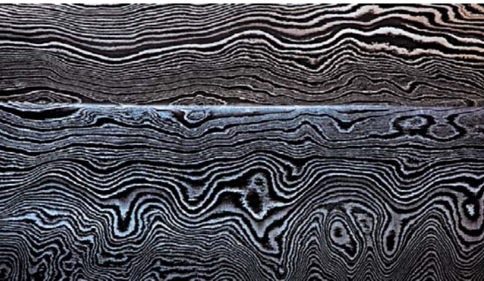
Schon die Schmiede aus Damaskus haben ihre Stähle bearbeitet, um sie zu härten: Sie schiedeten zum Beispiel verschiedene Stahlgüten zusammen. Beim sogenannten „Damaszener Stahl“ ist diese Struktur aus mehreren, sich abwechselnden Lagen gut zu erkennen.
